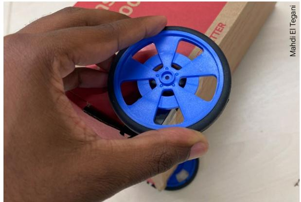
Schritt 5: Antriebsrad auf den Servomotor montieren
