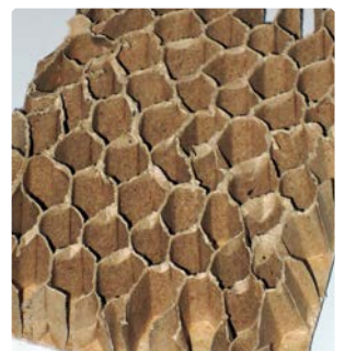
Ideen aus dem Bienenstock: sehr stabile und leichte Wabenplatten
