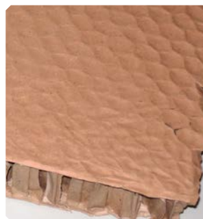
Ideen aus dem Bienenstock: sehr stabile und leichte Wabenplatten
