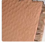
Ideen aus dem Bienenstock: sehr stabile und leichte Wabenplatten
