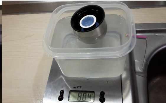
Wassertrog mit Schiffchen, Wasser wird verdrängt und läuft aus bis die Wasserhöhe wieder erreicht ist
