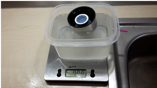
Schiffchen im Wassertrog liefert wieder dieselbe Masse wie ohne Schiffchen (778 Gramm)
