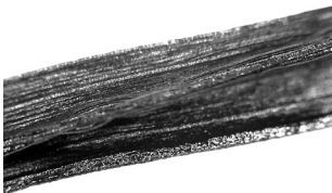
Carbonfaser unter dem Mikroskop
