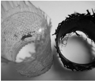
Rohre aus glasfaserverstärktem Kunststoff (GFK, links) und carbonfaserverstärktem Kunststoff (CFK, rechts)
